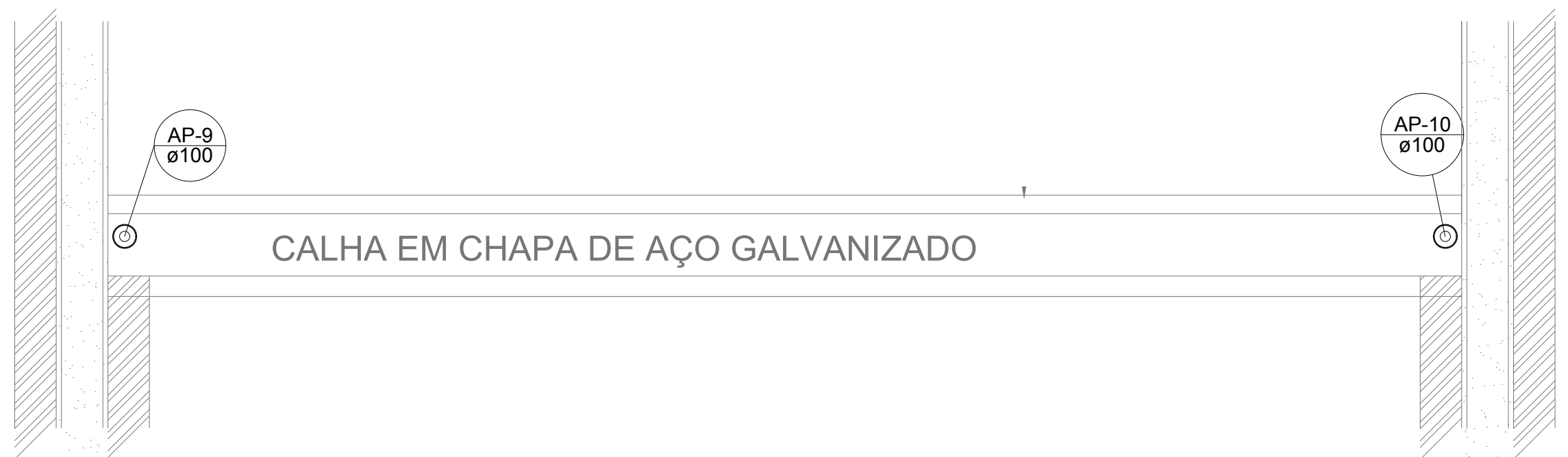
Detalhe S4 escala 1:25
